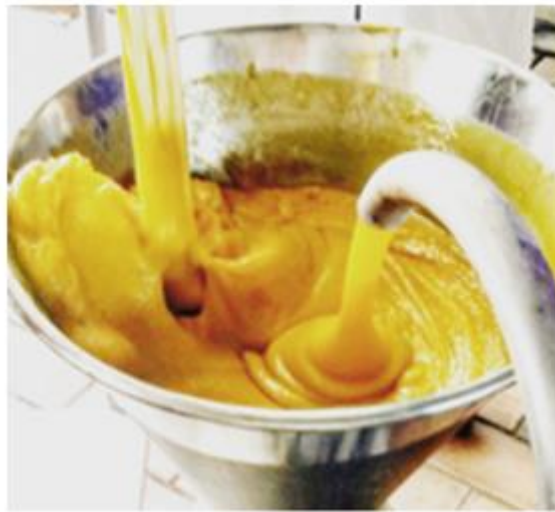
Figura 12 – Homogeneização da polpa com os coadjuvantes em moinho coloidal Fonte: acervo pessoal
