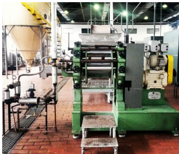
Figura 13 – Drum dryer da Planta de Desidratados do FRUTHOTEC/ITAL Fonte: acervo pessoal
