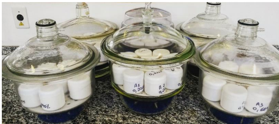
Figura 16 – Dessecadores com as amostras do estudo de isoterma de 25°C e 35°C. (Fonte: Acervo pessoal)
